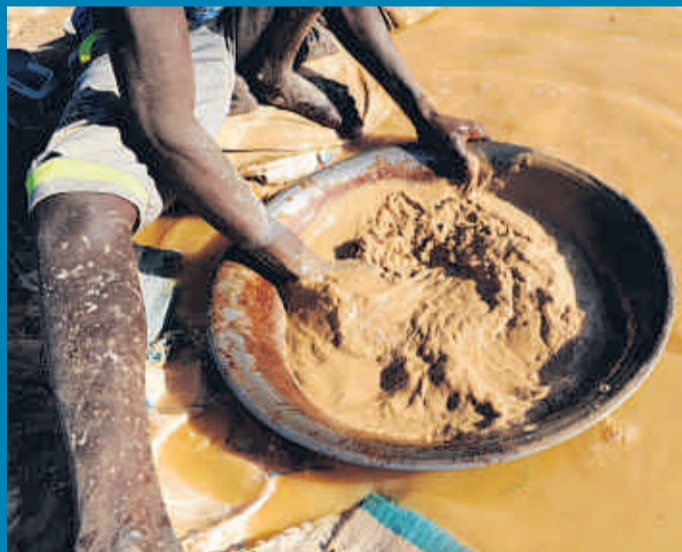
In einer Schüssel wird der Goldstaub aus dem Gestein gewaschen.
